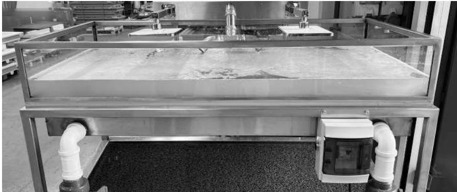
Il est important de noter que même si Aquastop est très efficace, il ne peut garantir une étanchéité parfaite, dans toutes les conditions. Des gouttes ou de petits jets d'eau peuvent traverser l'étanchéité, même lorsque Aquastop est en position de travail.
