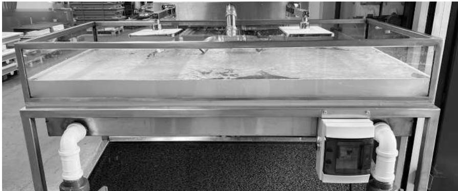
Die Abdichtung der Lüftungsöffnungen ist zwar gut, aber nicht absolut dicht. Es kann vorkommen, dass Tropfen oder kleine Wasserstrahlen auch bei aktiviertem Aquastop eindringen. Nach jedem Ereignis muss Aquastop manuell in die horizontale Ausgangsposition zurückgestellt werden.
