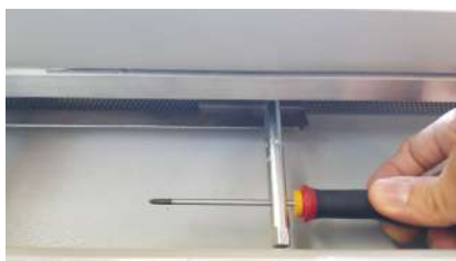
Gebruiker 2: Gebruik de schroevendraaier voor extra kracht en om de afdichting te verzekeren.
