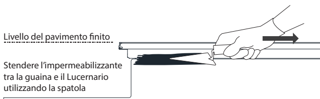
Figura E: Applicazione della guaina liquida/impermeabilizzante liquido con spatola.
