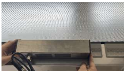
Utente 1: posizionare l'aspiratore in modo che le barre filettate attraversino i fori
