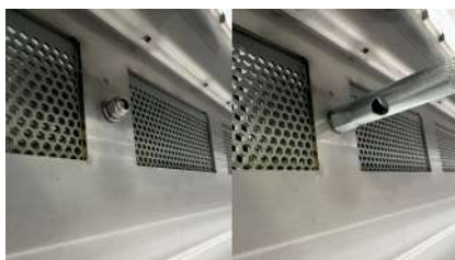
Utente 2: Inserire la rondella e il dado autobloccante e serrare con la chiave
