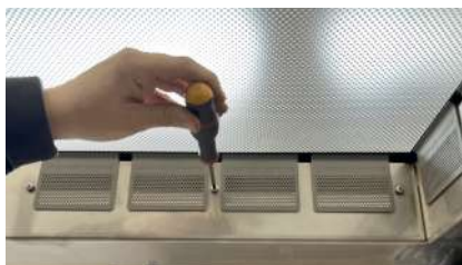
Utente 1: Dall'interno, svitare a partire da sinistra, la prima e la seconda vite
