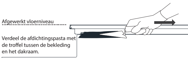
Figuur D: Aanbrengen van de vloeibare bekleding/afdichtingspasta met een plamuurmes.
