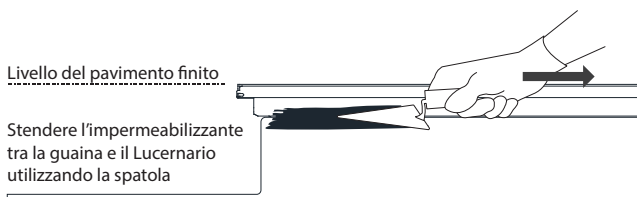
Figura D: Applicazione della guaina liquida/impermeabilizzante liquido con spatola.
