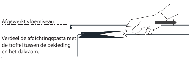
Figuur E: Aanbrengen van de vloeibare bekleding/afdichtingspasta met een plamuurmes.
