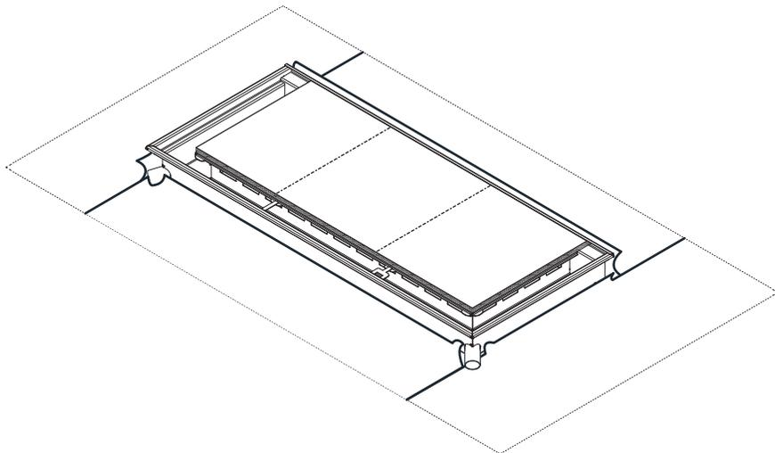
*Figure B : Pose du revêtement pour une installation contre un mur.*
